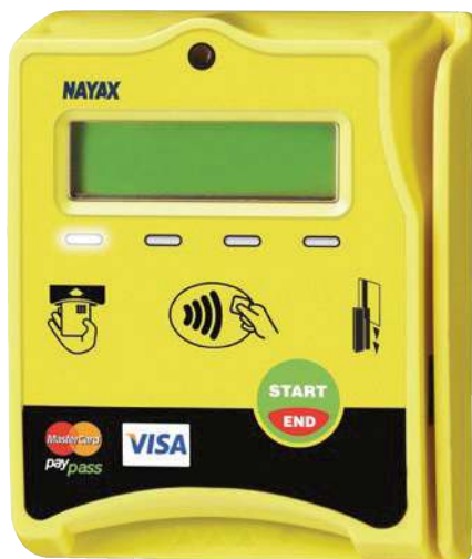
Die Interaktion erfolgt u. a. über ein 2,4-Zoll-Color-Touch-LCD-Display und sechs Soft-Touch-Tasten.
